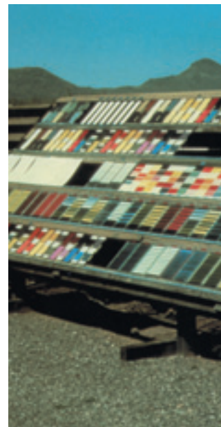
Рис. 3. Испытание образцов профиля на ксенотест-машине в лаборатории и в натуральных условиях
