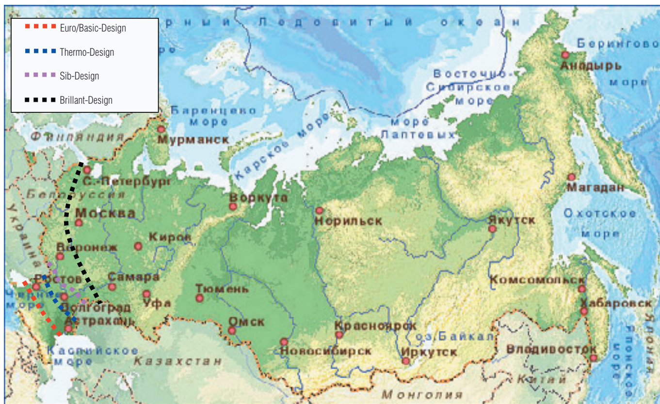
Рис. 3. Границы применения оконных блоков из профилей различных систем RENAУ со стеклопакетом 4M1-16-4M1 на территории РФ
