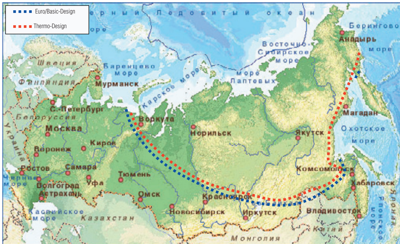
Рис. 4. Границы применения оконных блоков из 60-мм профильных систем RENAU со стеклопакетом 4M1-Ar10-4M1-Ar10-И4 на территории РФ
