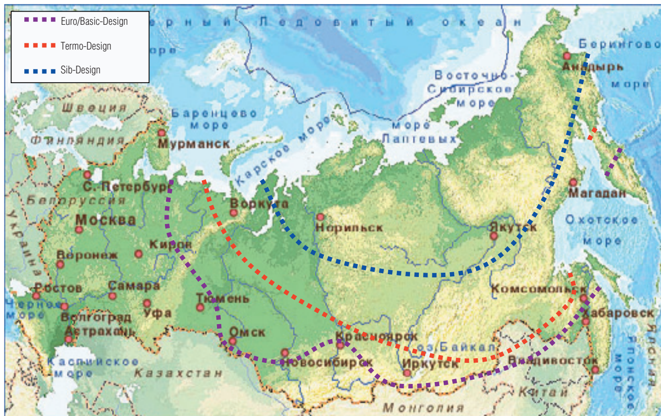
Рис. 5. Границы областей применения оконных блоков из профильных систем RENAУ, определённые из условия равенства сопротивлений теплопередаче системы профилей и стеклопакета, R_{0\text{ проф.}} = R_{0\text{ ст.}}
